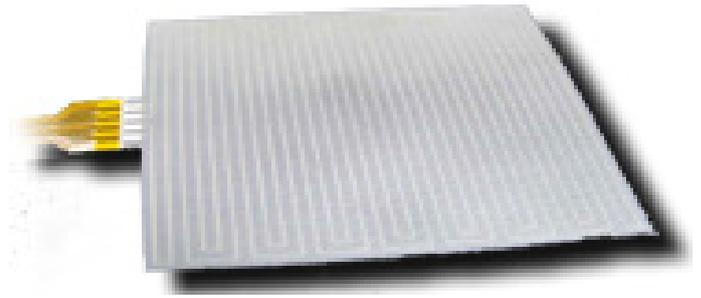
Heizfolien können exakt auf die Maße des LCDs bzw. eines LCMs gefertigt werden und haben meist eine Dicke von wenigen Zehntel-Millimetern. Platziert wird die Heizfolie dann als Zwischenlage hinter dem Display, beziehungsweise dem Backlight. Die Heizfolie wird separat vom Display angesteuert und betrieben. Ein Punkt, der im Handheld- und Batteriebetrieb natürlich seine Berücksichtigung in Puncto des zusätzlichen Stromverbrauchs finden muss.
