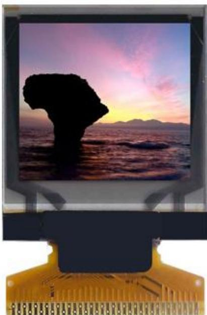
Während LC-Displays mit Backlight bauartbedingt erst ab ca. 4,0mm angeboten werden können, stehen PMOLEDs bereits mit einer Dicke zwischen 1,3-2,0mm zur Verfügung. Ein Vorteil für Anwendungen, die mit jedem Zehntel an Bauhöhe rechnen müssen.
