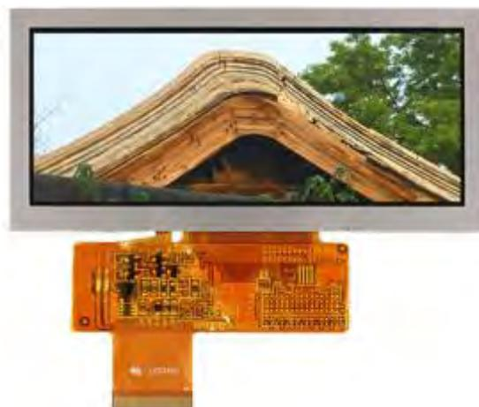
Die angebotene 3,9“ Version mit der Modulgröße von 105,5 x 40,64mm ist passend zum 1HE Standard mit einer Bauhöhe von 44,45mm. Analog zur 1HE werden 4,6“ TFTs mit einer Moduldimension von 120,7 x 57,08mm, sowie 7,84“ mit einer Abmessung von 203,48 x 70,60mm angeboten. Beide Größen können beispielsweise in 2HE Gehäusen (88,90mm Bauhöhe) Verwendung finden. Die Temperaturbereiche der TFTs sind jeweils für Industrieanwendungen auf -20°C bis +70°C (Op.Temp.) hin ausgelegt.
