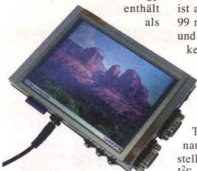
Kernstück das Computer-on-Module *MT-COM 1* mit einem ARM9-Mikrocontroller, der mit einer Frequenz von 400 MHz arbeitet.
