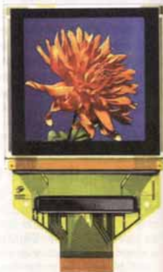
Das Grafikdisplay (UG-2828-GFEAF-01) von Univison Technology hat eine Auflösung von 128 x 128 Pixeln, der Blickwinkel liegt bei über 160° und der Kontrast bei 1:100. Einsetzbar ist die Anzeige im Betriebstemperaturbereich von -20° bis 70° C.
