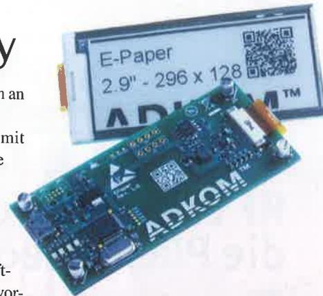
Für das einfache Übertragen von Texten und Grafiken auf E-Paper-Displays sorgt Adkoms eigens entwickelte Steuerplatine.
